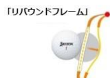
「リバウンドフレーム」 フェースとフレームを一体化させることでたわみを増幅
