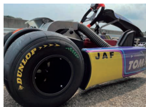
「2023年全日本カート選手権」EV部門第3戦に装着したサステナブル原材料比率を高めたカートタイヤ
